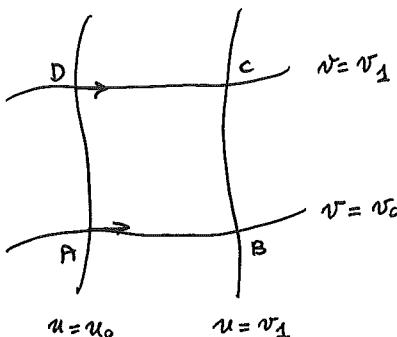
$\underline{x}_u$  è il vettore tangente alla linea coordinate  $\underline{x} = (u, v_0)$  e  $\underline{x} = (u, v_1)$
